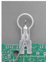
熱風温度検出用エアセンサー
